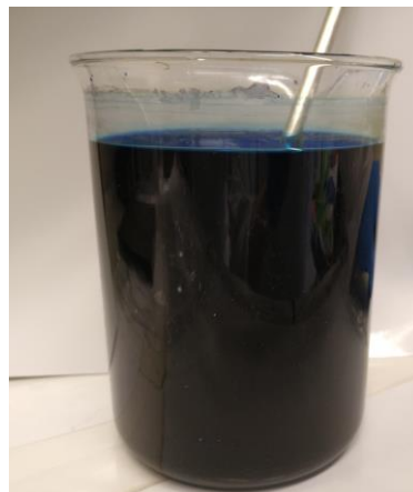
Abbildung 2 – mit Methylenblau angefärbte wässrige Kurkuma-Dispersion.
